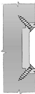
Fijación gracias al sistema patentado por AGB con tornillos inclinados de 3,5 mm que desaparecen en el interior del soporte.
