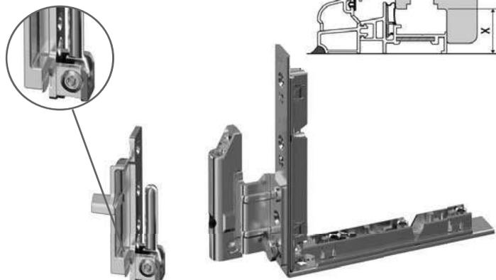
La bisagra angular ha sido reforzada en los puntos de mayor esfuerzo para incrementar la capacidad. Está disponible en la versión con y sin adaptador 16/12. Cuando el travesaño de aluminio lo permite ( $X > 22$  mm) se puede utilizar la misma bisagra en balcones. El soporte de la bisagra es realizado con la tecnología de la doble soldadura para garantizar la capacidad en caso de golpes accidentales.
