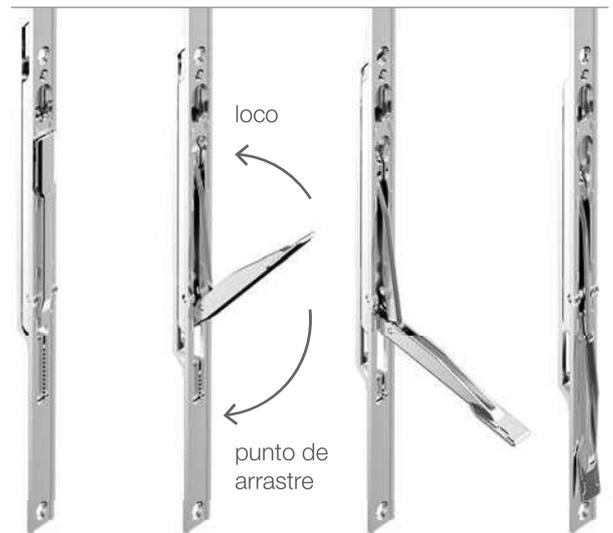
El pasador pasante con leva frontal garantiza la función antivandalismo de la ventana de dos hojas. Si se arranca el nudo central, la leva no puede ser accionada tirando desde el exterior: la hoja en posición de cierre impide el movimiento de la leva. El movimiento frontal permite además ejercer una fuerza mayor para mover los múltiples puntos de cierre de la hoja pasiva.
